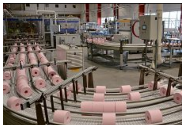
Sur la ligne de fabrication des rouleaux de papier toilette sans tube.
