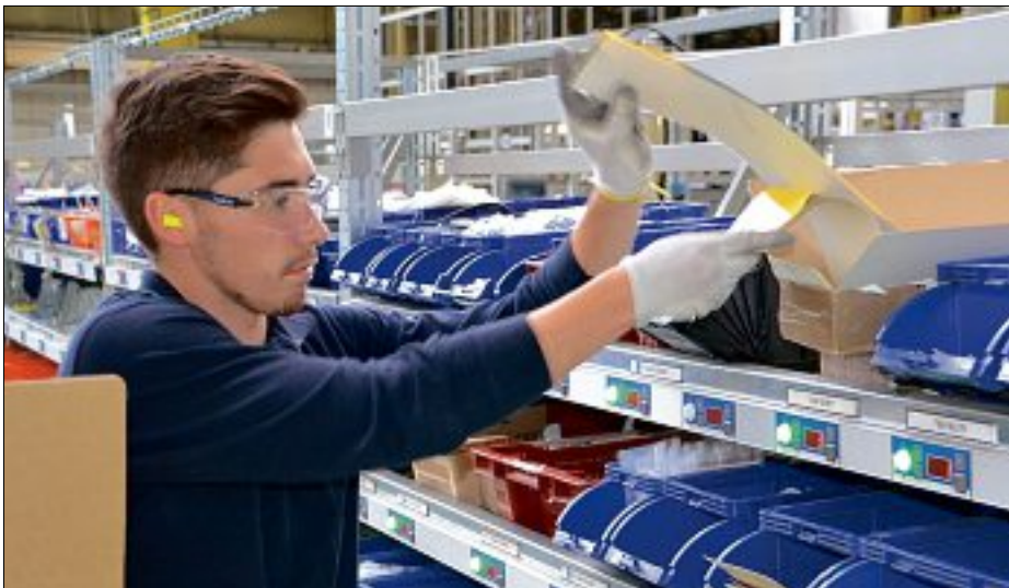
Pour les magasiniers, l'emploi d'un système de lumières dans le rayonnage a permis de diviser par deux les oublis et erreurs d'éléments dans les cartons partant à l'export.
