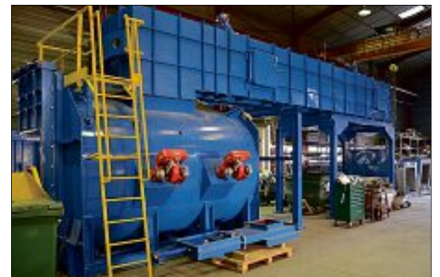
L'incinérateur de déchets hospitaliers à l'entrée du site.
